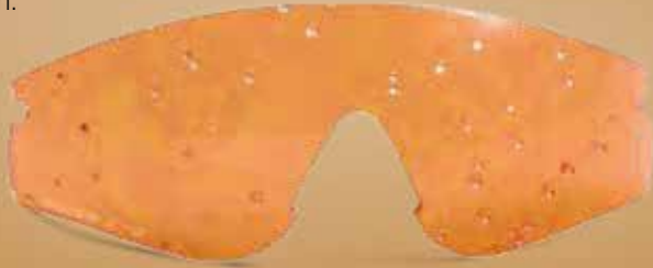
SWISS EYE Scheibe nach bestandenem STANAG Test / SWISS EYE lens after passed STANAG test
